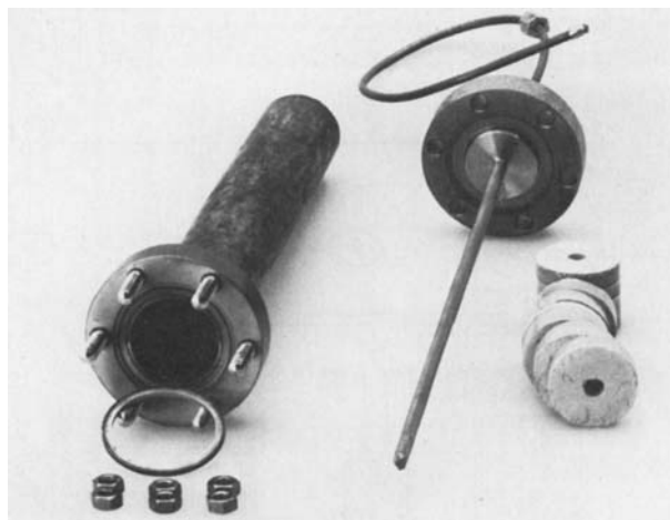
Abb. 8. Verpreßtes, luftstabilisiertes Mg/MgH 2 -Speichermaterial mit Hydridspeicherrohr (Zentrale Forschung der Daimler-Benz AG).
